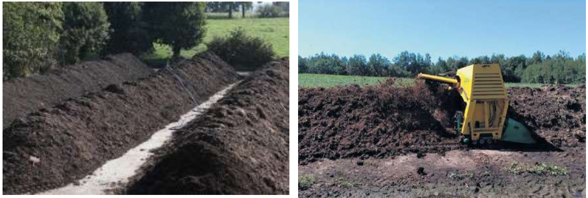
Figure IV 2 : Technologie de compostage en andains retournés
